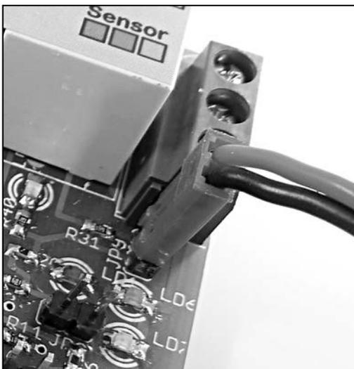
Bild links zeigt den Anschluss des Druckschalters durch ein zweiadriges Kabel mit rotem JST-Stecker (Art.-Nr. 9128, im Komplettsatz enthalten).
