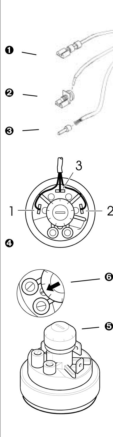
**Hinweis:** Am Einstellknopf versteteln Sie gleichzeitig den oberen Schaltpunkt (schaltet bei steigendem Druck) und den unteren Schaltpunkt (schaltet bei fallendem Druck).
