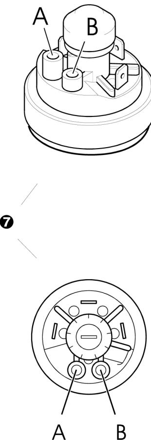
**Remarque :** Le bouton de réglage agit simultanément sur le point de commutation supérieur (commute lorsque la pression augmente) et le point de commutation inférieur (commute lorsque la pression diminue).
